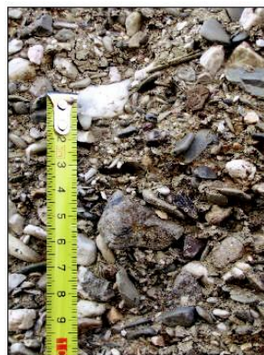
5. ábra: A bányafal 2. rétegének alsó határa (vaskéreg), illetve a réteg kavicsanyaga
